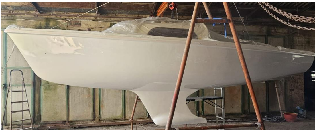
Figura 17: lo scafo dopo due mani di primer.
