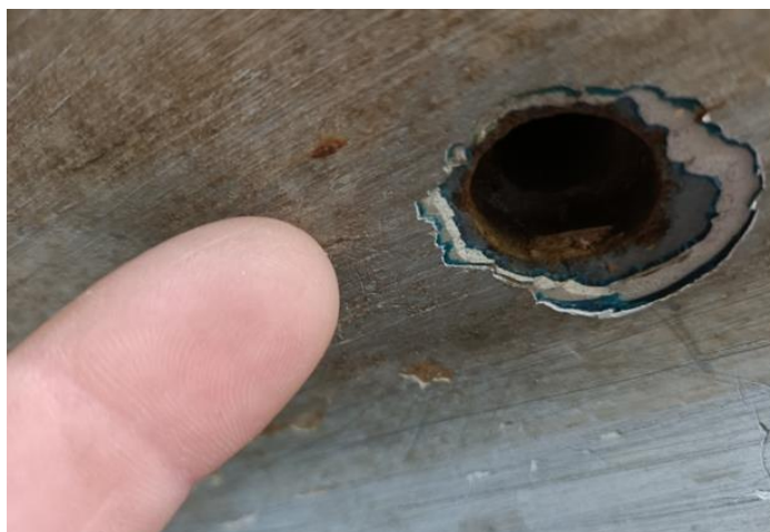
Figura 5: i fori sull'opera viva lasciati dalle teste delle viti del bulbo.
