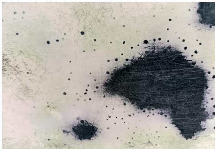
Figura 11: bollicine e distacchi fra gli strati di vernici, primer e gelcoat.
