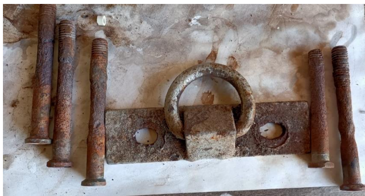
Figura 4: viti del bulbo e anelli da sollevamento ammalorati.
