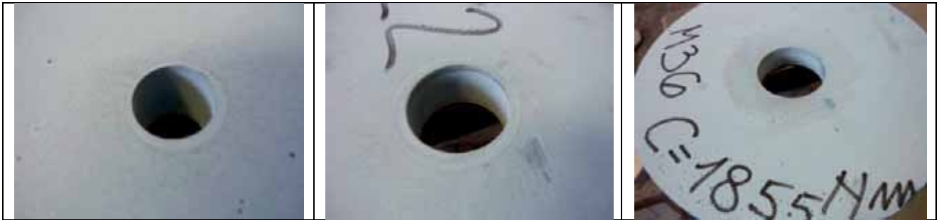
Aspetto delle zone centrali forate dei singoli campioni dopo prova di compressione mediante serraggio bulloneria.
