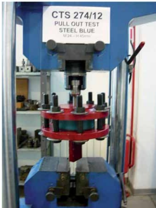
Particolare della disposizione del campione di resina per prova PULL OUT (M24 – H 45mm).
