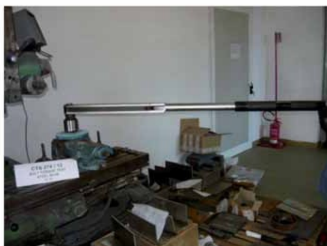
Particolare della disposizione di prova per serraggio bullone M36.
