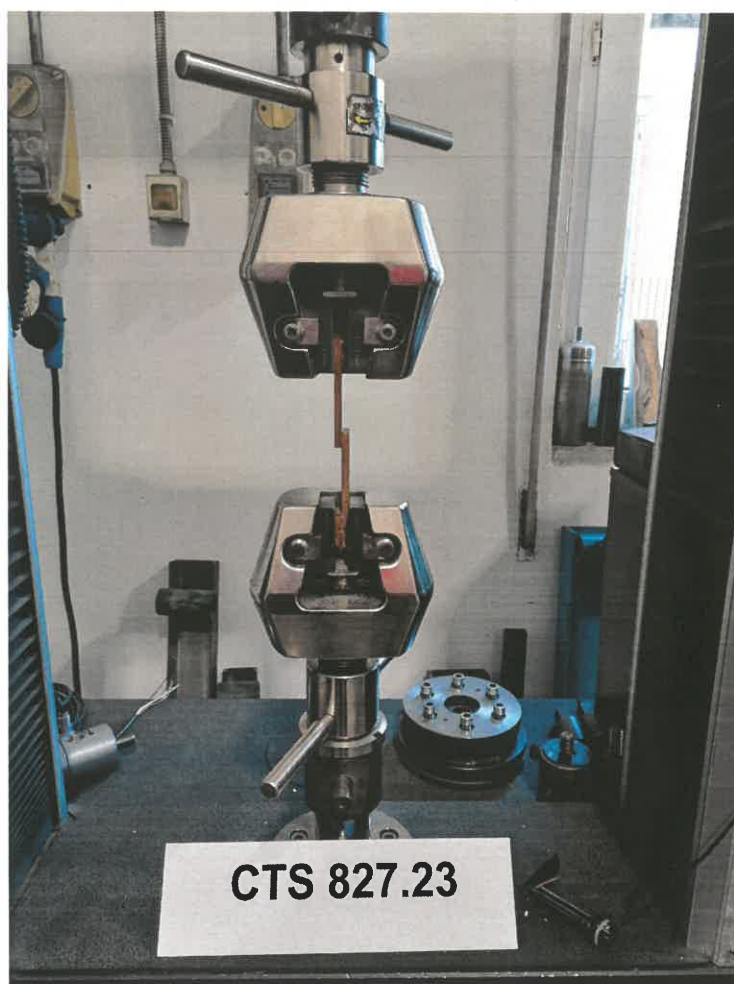
Fig. 5 – Disposizione tipica di una provetta di taglio su macchina di prova
