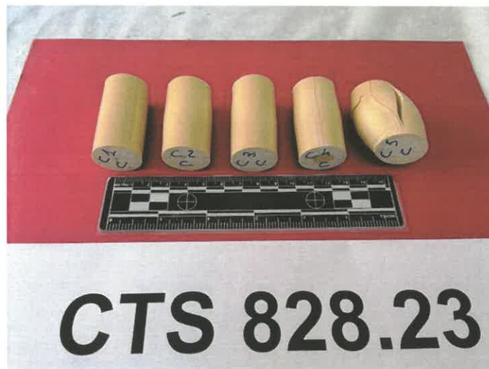
Figg. 5 – 6 Aspetto delle provette di compressione al termine della prova
