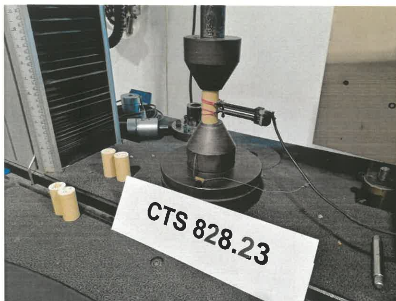
Fig. 4 – Particolare della disposizione provetta di compressione su macchina di prova
