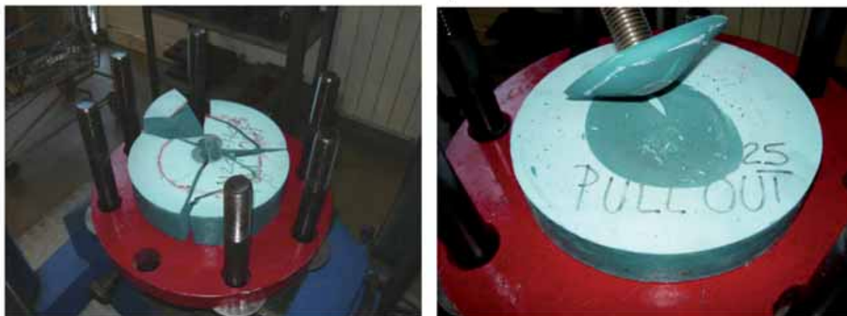
Aspetto dei campioni [M24 – H45] e [M24 – H25] dopo prova di PULL OUT.
