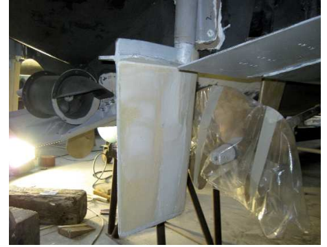
Il timone viene stuccato con 10 10 CFS e MicrofillerPowder
