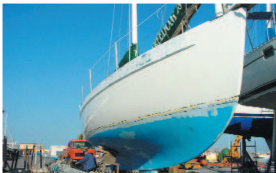
Le fiancate della barca tornano come nuove dopo l'applicazione dello smalto
