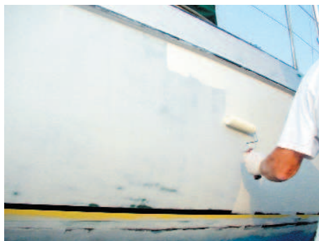
Applicazione a rullo dello smalto dopo il fondo di Epoxy Primer
