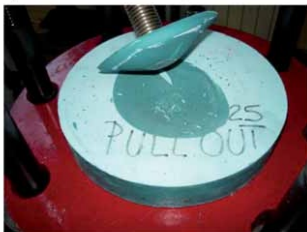
Aspetto dei campioni [M24 – H45] e [M24 – H25] dopo prova di PULL OUT.
